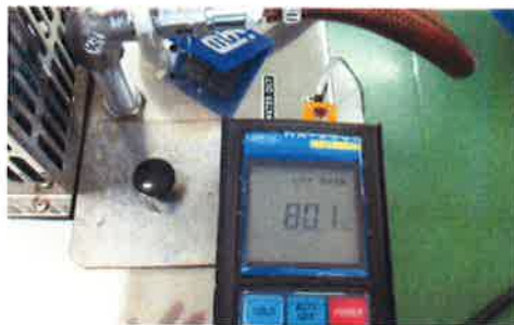
設定80℃の運転での温度測定
