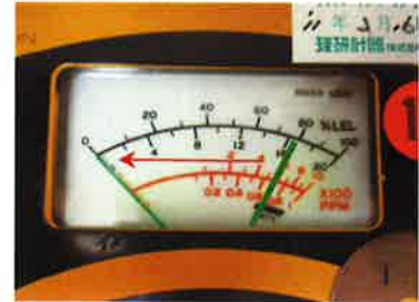
電源ON後、100PPMの位置 にてZERO調整
