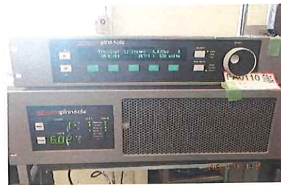
UNIT B 538V,11.19A, 6.022KW 出力状況
