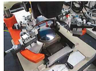
摺動部・上下動 チャック真空確認
