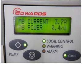
DP電流値: 4.8A                      到達圧力: 0.029Pa                      MBP電流値: 3.7A
