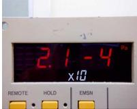
・NORMAL表示時の到達圧力:  $2.1 \times 10^{-4}$  Pa
