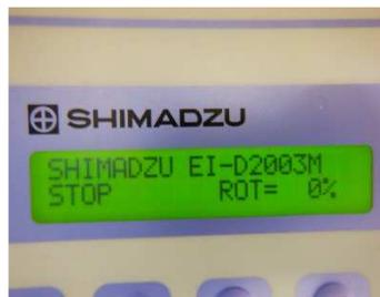
・PUMP STOP ⇒ BRAKE表示(減速中)
