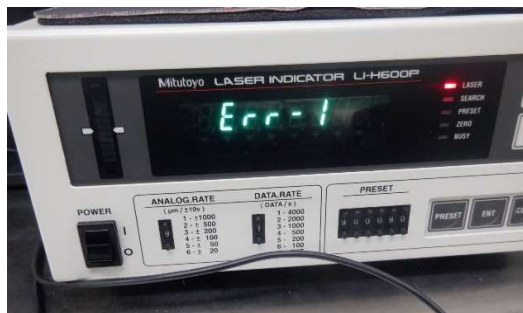
立ち上げ時にエラーが出る。(レーザーのエラー)
