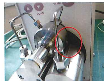
ポンプ吐出ポート右側吐出確認
