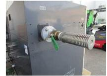
吐出口バルブ全開で 吐出圧力 0.56MPa確認
