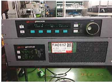
UNIT A 531V, 11.30A, 6.002KW 出力状況
