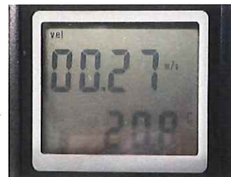
吹出風速測定
