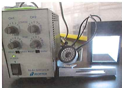
CH1スイッチ(MAN)投入 (電源の調光器にてMIN-MAX確認)
