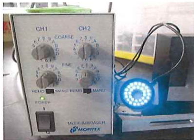
CH2スイッチ(MAN)投入 (電源の調光器にてMIN-MAX確認)
