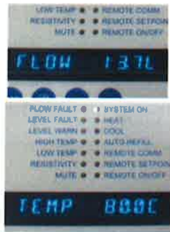
②設定80℃の運転状態
