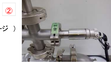
② ・使用測定ゲージ:MG-2(アネルバ製検査用)
