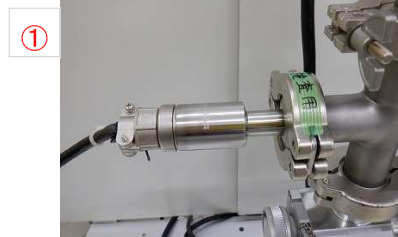
① ・使用測定ゲージ:MG-2(アネルバ製検査用)
