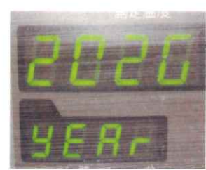
2020表示時の不点灯箇所
