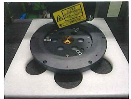
付属治具を用いて"0"補正
