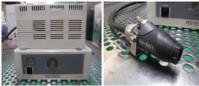
上: 高圧電源部
