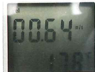
吹出風速測定
