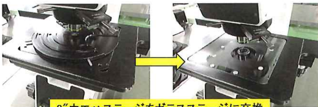
8"ウエハステージをガラスステージに交換
