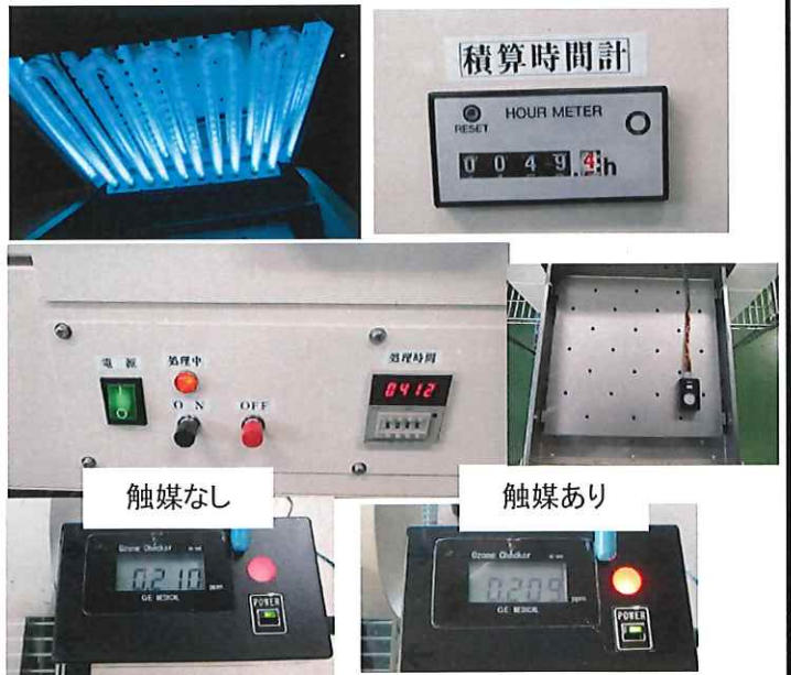
UVランプ照射時の各部動作状態
