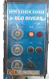
【操作パネル】 ・各タイマー設定 ・電源ON・OFFスイッチ
