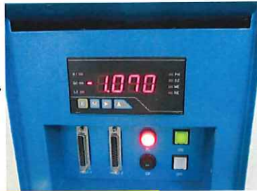
ゲージブロック"1mm"高さ計測誤差の確認
