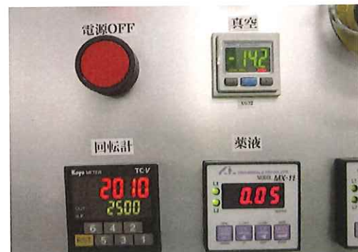
回転数2000rpm及び真空安定確認 (※SET:5000rpm 3000rpmまでは確認済)
