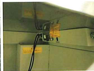
ガス電磁弁、真空ポンプ、フットSW取り付け部(フットSW、1個付属)
