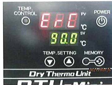
アラームAL H作動時とアラームAL C作動時
