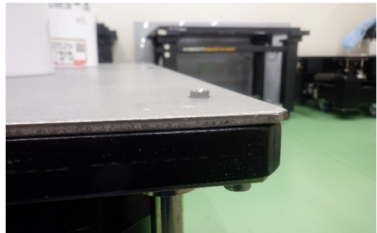
天板上に留めネジが出ている。6ヶ所
