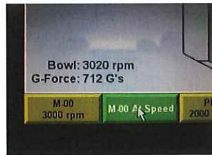
MANUALモード (3000rpm設定及び動作確認)
