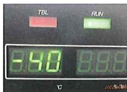
運転中の本体表示器(左から-40℃、+100℃、過昇防止器動作時)
