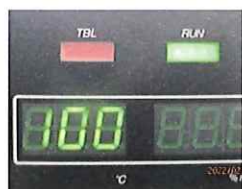
運転中の本体表示器(左から-40℃、+100℃、過昇防止器動作時)
