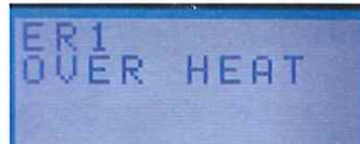
運転中のキーパッドの表示(左から-40℃、+100℃、過昇防止器動作時)
