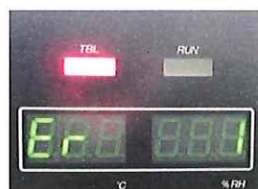
運転中の本体表示器(左から-40℃、+100℃、過昇防止器動作時)
