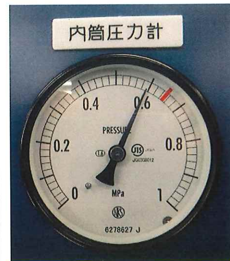
設定0.6MPa, タッチパネルの表示は0.60MPa
