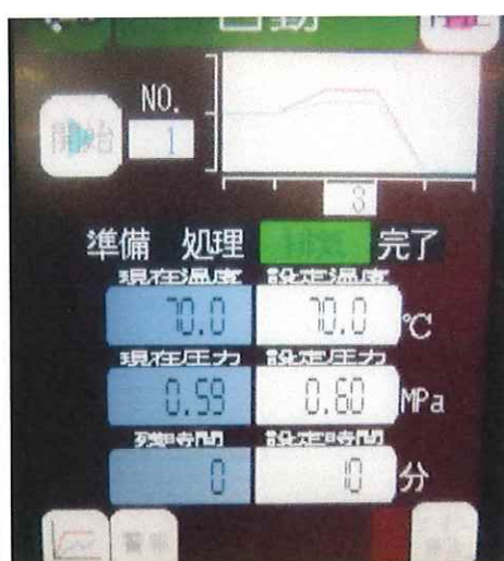
自動運転 70°C, 0.6MPa, 10分処理直後
