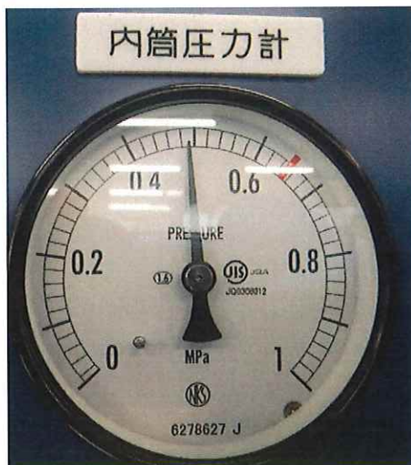
設定0.5MPa, タッチパネルの表示は0.50MPa
