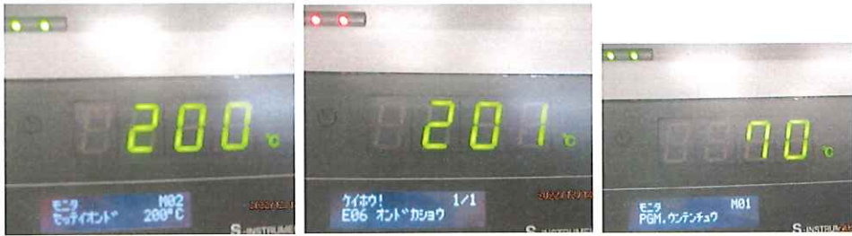
200°C定値運転画面と過昇防止器作動時画面 プログラム運転中
