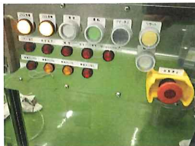
廃液タンクH表示でマグネットポンプ始動、排水。
