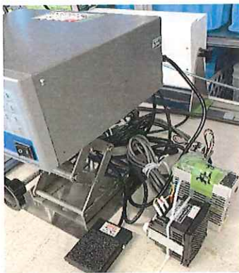
I/Oコネクタに繋いだ社内治具 入力:フットスイッチ/出力:ブザー
