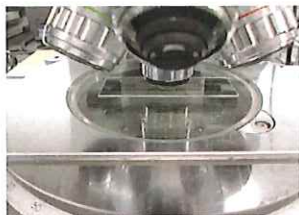
ブロックゲージ25mmを計測 対物レンズ10x
