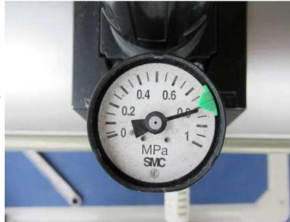
・1次圧力0.3MPaでブースターレギュレータが作動。
