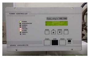
\*FAILURE発報 TMPスタート不可の為、動作確認中止。
