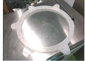
押さえプレート固定部一部欠損
