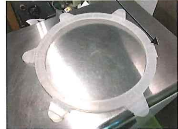
押さえプレート固定部一部欠損
