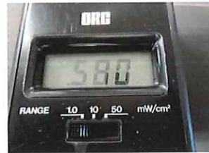
機器本体、照度計プローブ 距離15mmにて計測 結果:0.580mW/cm 2
