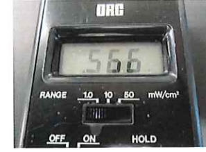
機器本体、照度計プローブ 距離15mmにて計測 結果:0.566mW/cm 2
