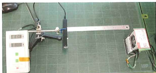
社内計測器NK-7001により除電確認。
