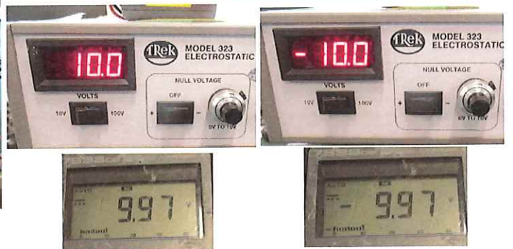
ヌル電圧源の電圧測定と表示電圧のアナログ出力電圧測定
