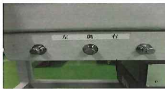
除振台エア供給口
