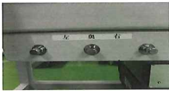
除振台エア供給口
