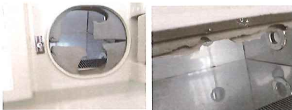
パッキン等破損
