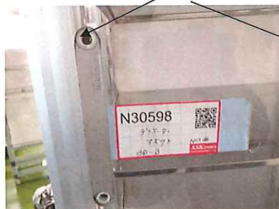
トッテ蓋欠損
