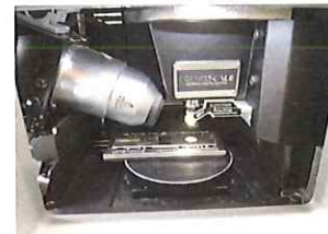
観察試料:表面粗さ標準片(0.45μmを測定)
