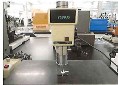
ゲージブロック25mmを測定
