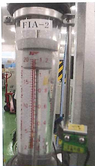
送水ポンプ出口:20L/min以上
