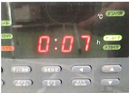
タイマー運転(残り7分の状態)
