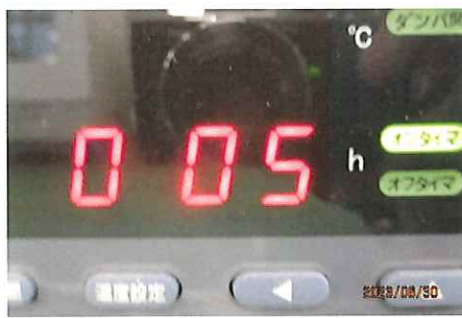
タイマー運転(残り5分の状態)
