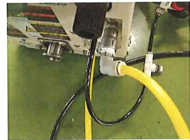
水導入配管、接続プラグ無し。
